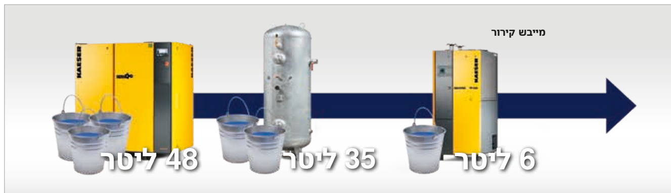
איור 1: הייצור, האחסון והטיפול באוויר הדחוס יוצרים משקעים. הכמויות הרשומות מתייחסות למשמרת של 8 שעות עבודה, בטמפרטורה של 20^\circ\text{C} , 60\% H_{\text{rel}} , 10 \text{ bar}_{\text{abs}} , 10 \text{ m}^3/\text{min}
