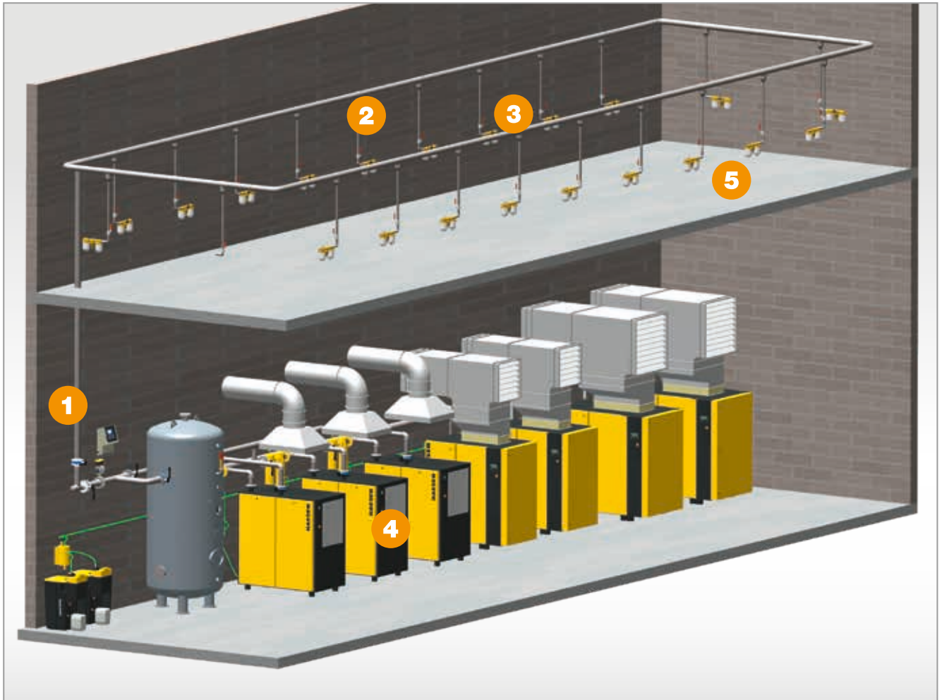
איור 2: החלקים העיקריים של מערכת חלוקת אוויר דחוס: קו ראשי (1), צנרת חלוקה (2), חיבור צנרת (3), מייבש (4), FRL יחידה/צינור (5)
