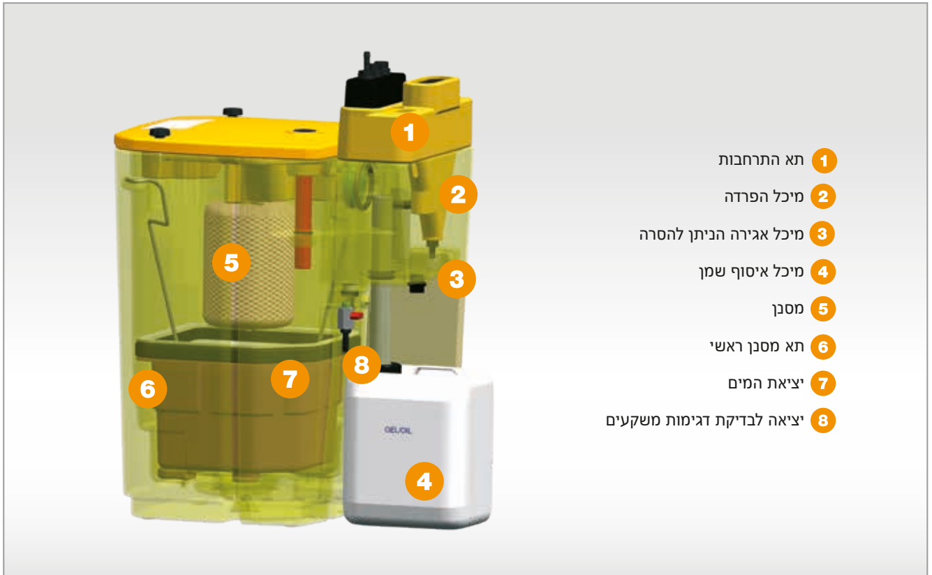
איור 2: מערכת הפרדת משקעים מהאוויר הדחוס באמצעות טכנולוגית כוח הכבידה.
