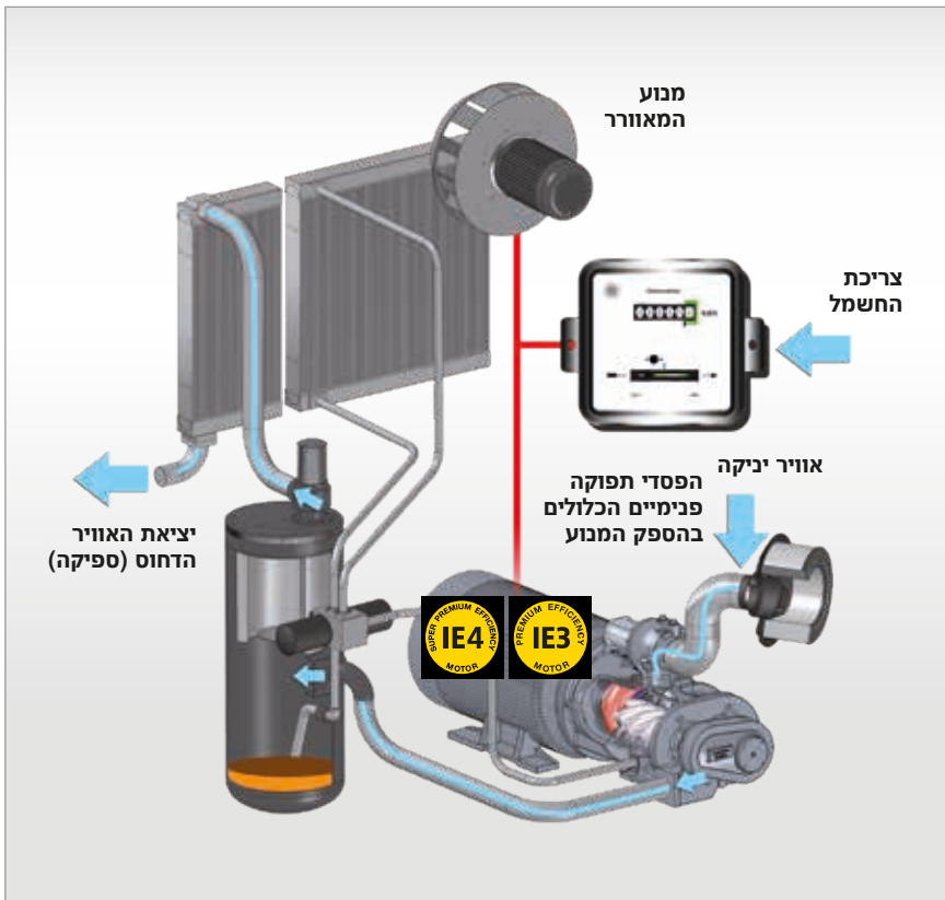
איור 2: תרשים עיקרון פעולת המדחס הבורגי, הגדרת ההספק המוגדר
